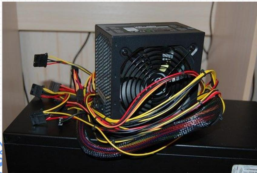
2. Fuente de Alimentación: Se encarga de alimentar de electricidad a todos los componentes del ordenador.
