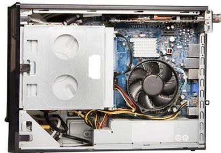
1. Chasis (caja o torre): Donde se guardan y se montan los componentes del ordenador.
