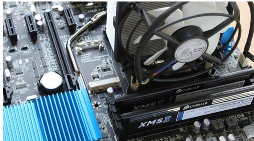
5. Disipador: Se función es la de mantener “fresquito” el procesador, ya que este desprende mucho calor durante su funcionamiento y no le gusta “pasar calor”
